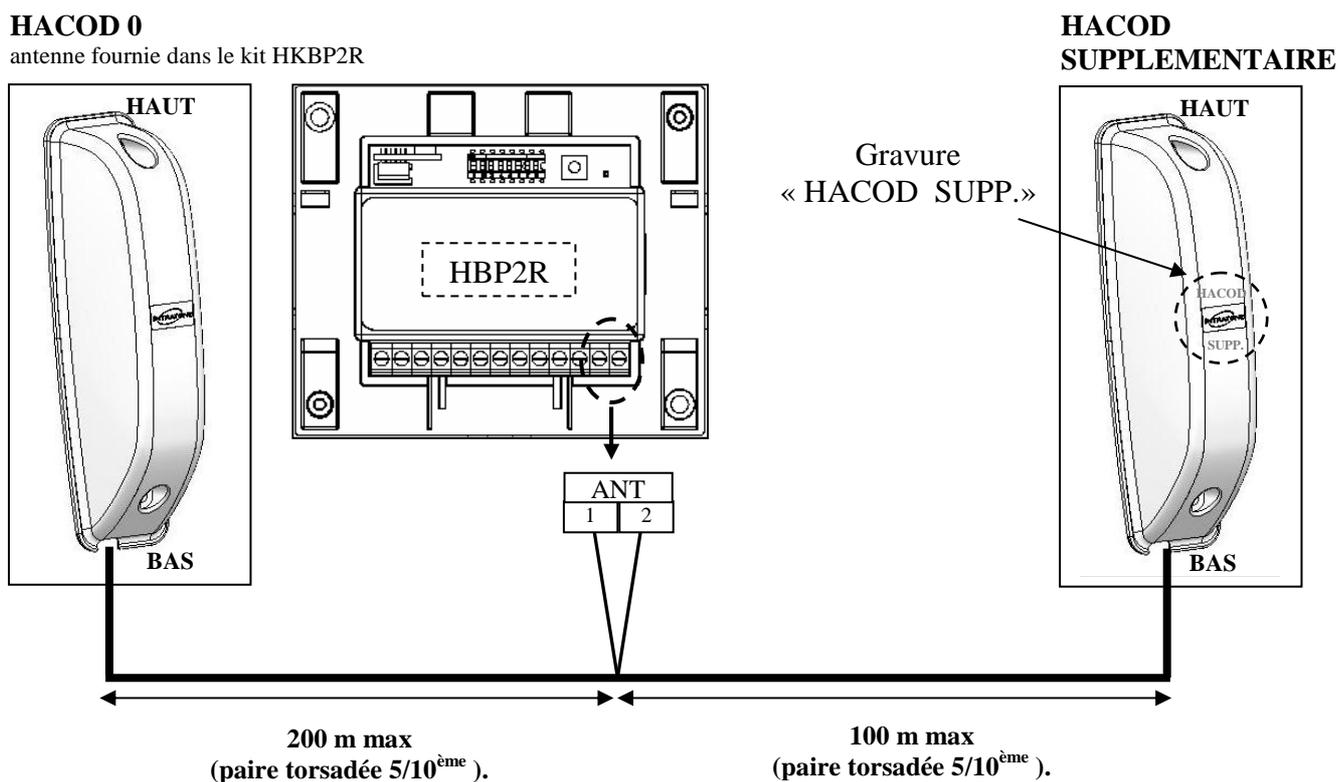
Branchement possible des antennes sur le boîtier parking :
