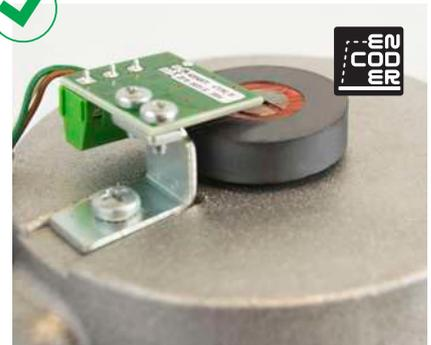
Contrôle du mouvement du moteur par encodeur qui garantit détection d'obstacles et sécurité maximales (seulement sur versions 230V)
