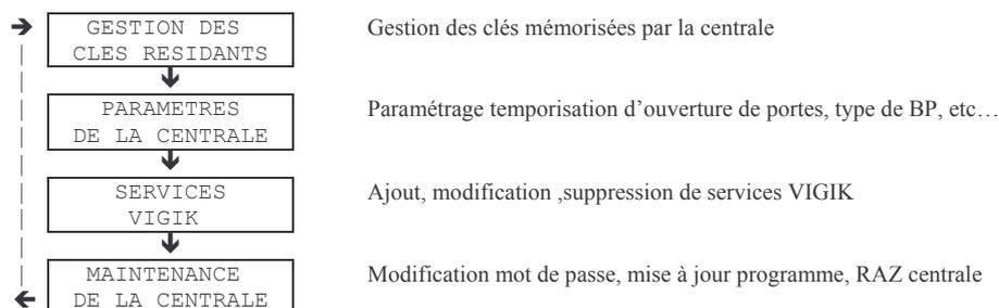
Les flèches indiquent le sens de parcours des écrans en utilisant la touche 'suivant' : ↵. La touche annulation permet de sortir du mode programmation.
