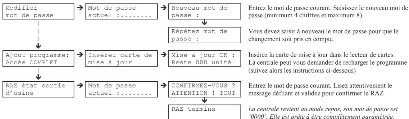
Le RAZ état sortie d'usine *remet la centrale dans la configuration neuve « prête à être installée » (mot de passe : '0000')*.
