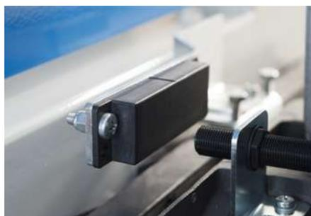
**Fin de course magnétique** pour cas spéciaux (seulement REV220/M, REV220RF/M et REV24/M).
