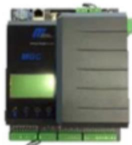
**Logique de commande** 24V DC MGC-PRO avec détecteur de boucles bi-canaux,
