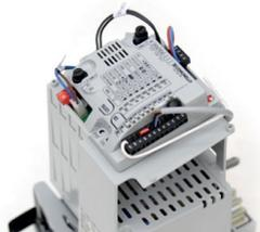
Logique de commande embarquée et récepteur intégré.
